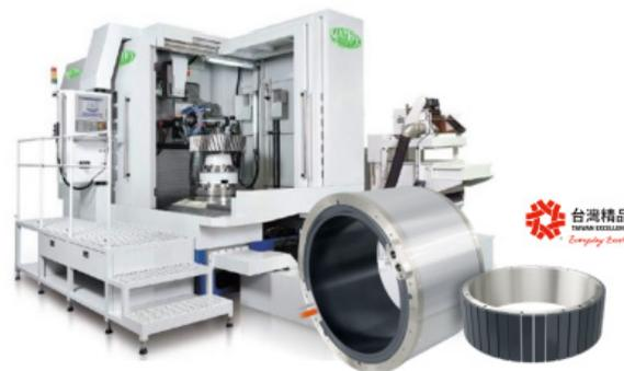
搭配水冷力矩馬達 - TM2 用於電動車齒輪加工之應用
