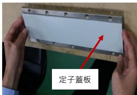
為避免使用人員受傷或者造成定子損壞，不得接觸定子蓋板邊緣來拿取定子。
