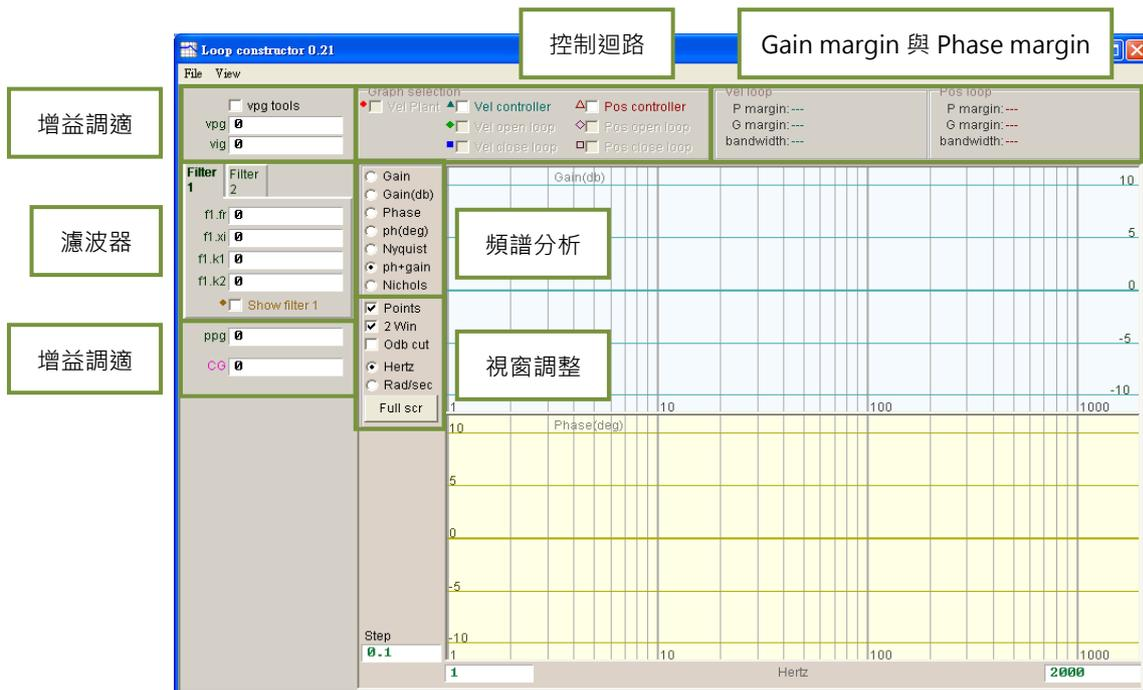
圖6.7.2 Loop constructor介面
