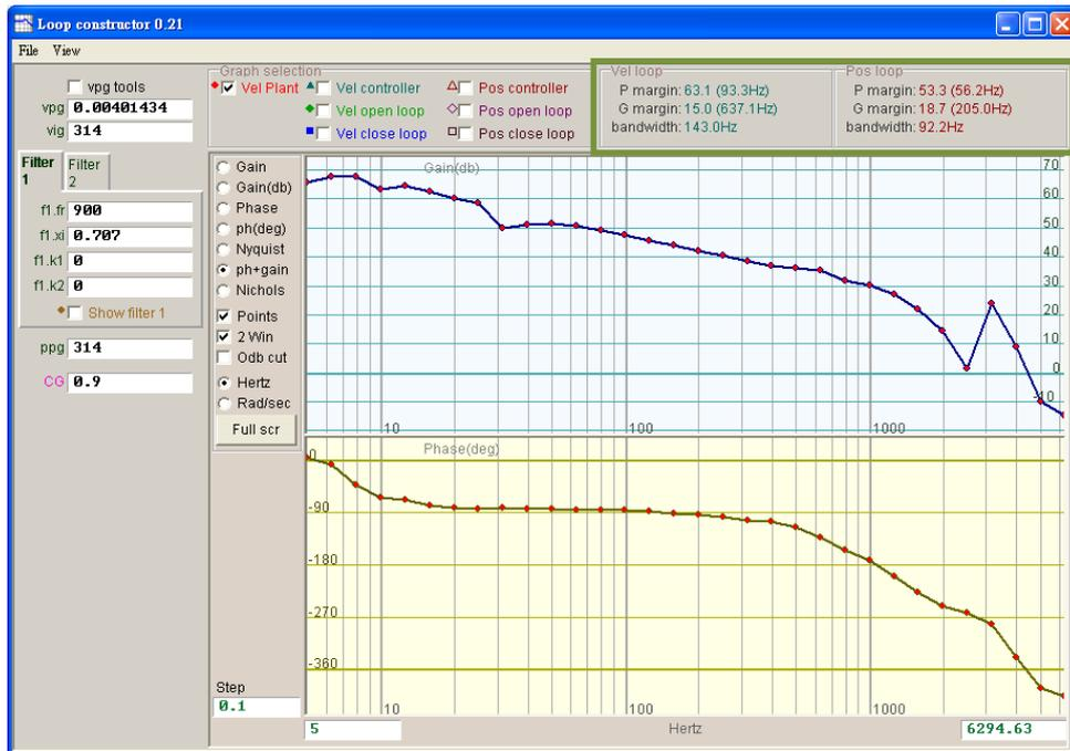
圖6.7.5.1 Loop constructor – P margin與G margin
