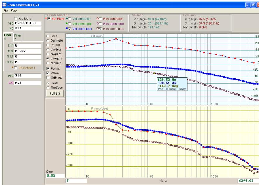
圖6.7.2.3.1 Vel close loop與Pos close loop的Bode圖
