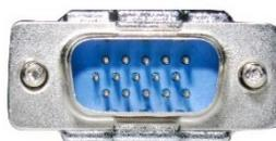
圖 5.2.1.4 D-sub VGA 15 Pin
