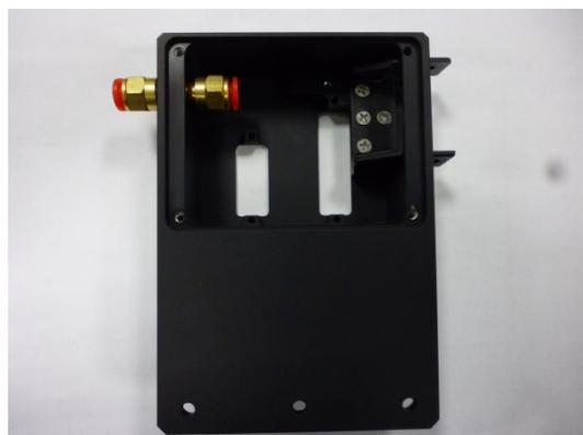
步驟 8:將馬達線接頭穿過接頭固定座後，使用銅柱將接頭固定(銅柱鎖緊即可，避免將銅柱鎖斷)。
