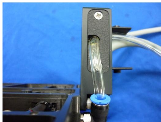
步驟 5:方型鏈條與方型鏈條法蘭(公端)接上後，使用束線帶將管線與方型鏈條固定。
