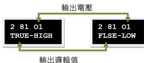
圖7.3.2 Output狀態顯示
