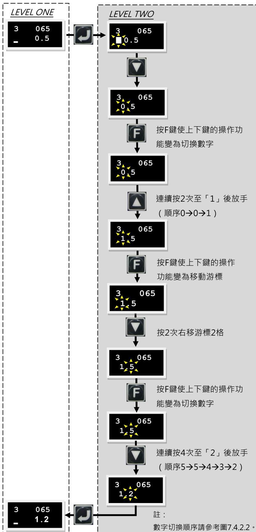
圖7.4.2.1 以common gain (LCD No. 065)為例之參數編輯操作圖
