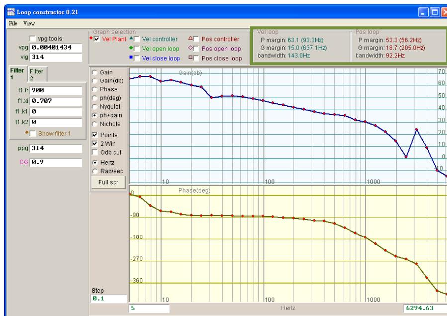
圖6.7.5.1 Loop constructor的P margin和G margin
