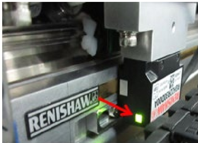
(b)Renishaw 讀頭間距為 0.8 \pm 0.15\text{mm}
