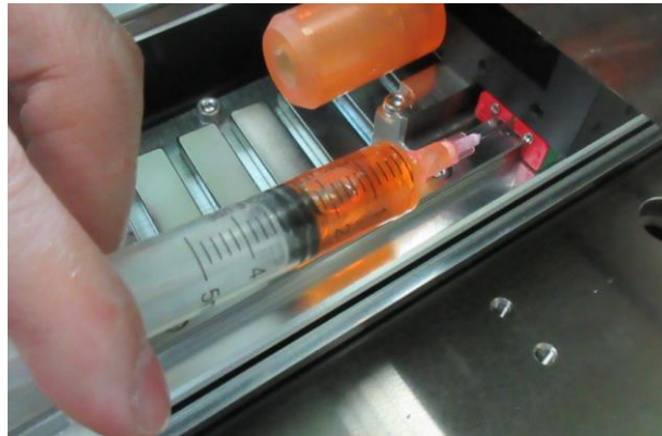
圖. 7.1.4.1.2 MGN 滑塊潤滑保養套件
