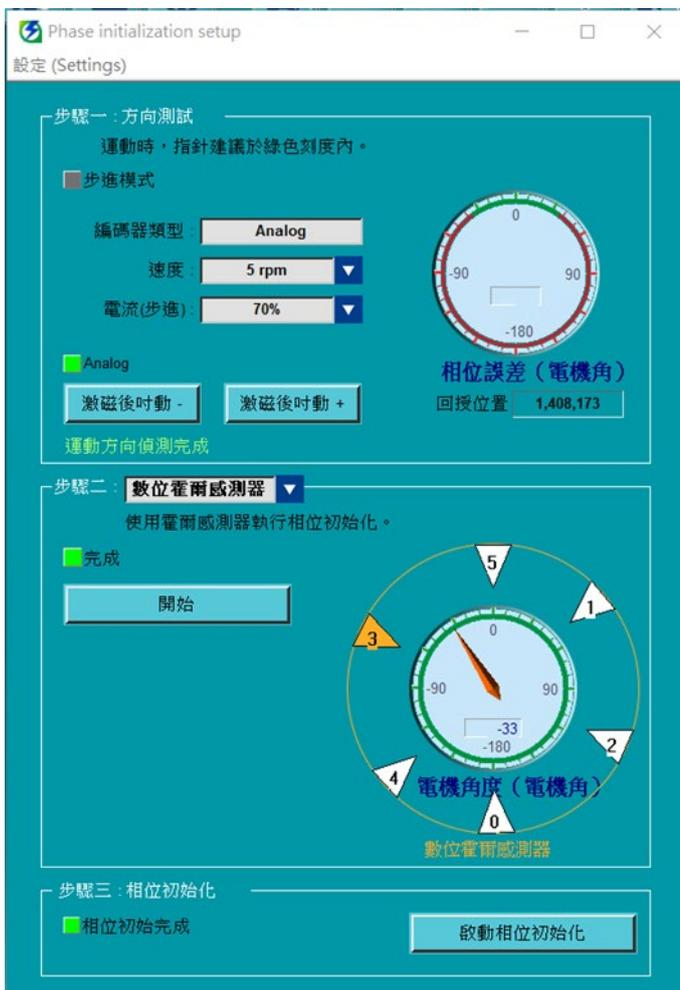
步驟一： 選擇執行電機角檢出的速度及電流。 點擊**激磁後吋動+**及**激磁後吋動-**按鈕來移動馬達。馬達移動時請觀察電機角是否落在綠色區域。
