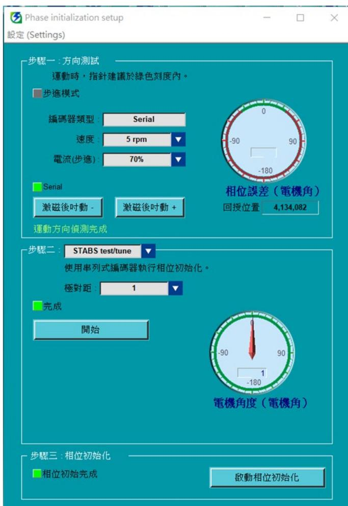
步驟一：選擇執行電機角檢出的速度及電流。點擊激磁後吋動+及激磁後吋動-按鈕來移動馬達。馬達移動時請觀察電機角是否落在綠色區域。
